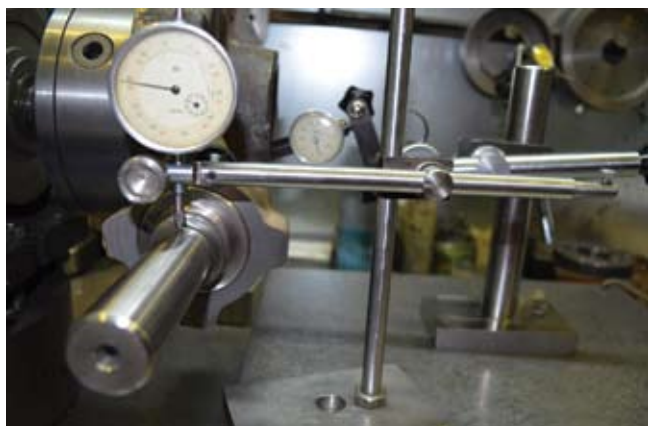
Рис. 3. Реализация традиционной схемы измерения межосевого расстояния в корпусе спироидного редуктора с использованием оправки
