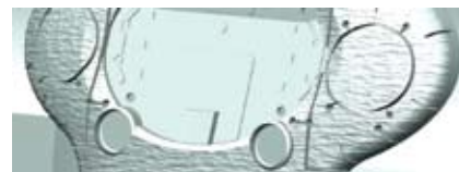
Рис. 7. Иллюстрация возможности выборочного наложения текстурированной 3D-поверхности на твердотельную деталь методом ортогональной проекции
