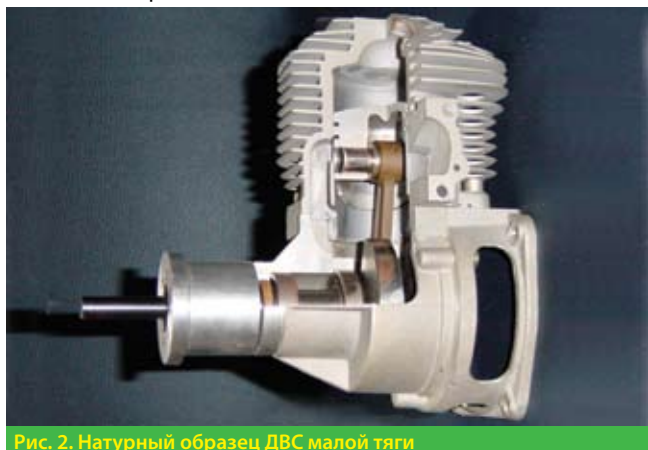
Рис. 2. Натурный образец ДВС малой тяги
