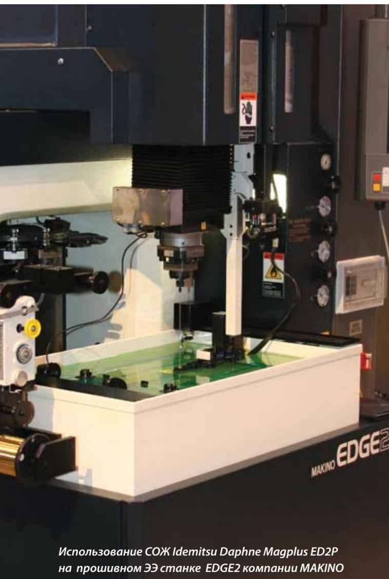
Использование СОЖ Idemitsu Daphne Magplus ED2P на прошивном ЭЭ станке EDGE2 компании MAKINO
