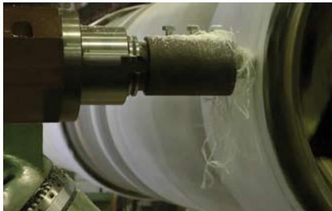
изводительные методы обработки: фрезоточение, резьбофрезерование, профильное фрезерование. В рамках проекта спроектирован и изготовлен специальный твердосплавный инструмент для обработки композитов, способный работать с подачами до 1000 мм/мин.
