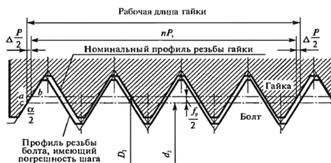
Рис. 3. Погрешность шага \Delta P/2 и её компенсация на среднем диаметре
