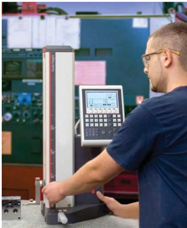
Высотомеры особенно восприимчивы к температуре. Касаться измерительного прибора только в местах, предназначенных для этих целей: ручки, пластина для опоры рукой, или выключатель для включения воздушных подшипников. Не касайтесь других элементов измерительной цепи.
