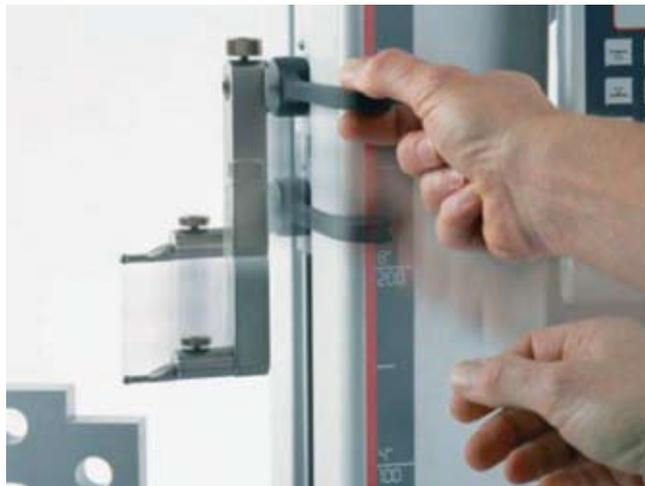
Некоторые модели имеют привод быстрой перестановки, который позволяет перемещать точку замера непосредственно в место проведения измерений.
