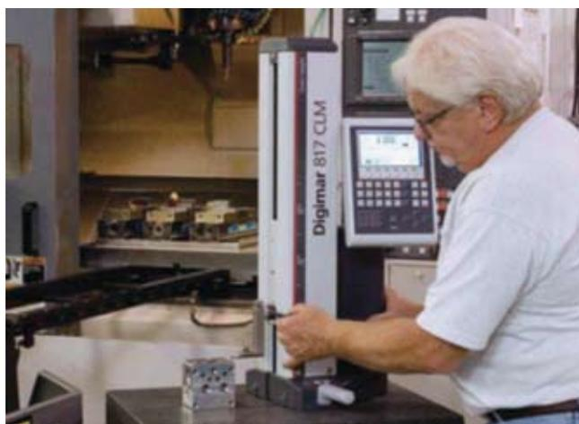
При готовности к измерениям задайте высоту базы отсчета относительно нулевой точки, передвиньте измерительную каретку к детали и нажмите клавишу измерения высоты, обеспечивающую перемещение наконечника сверху вниз. Электропривод обеспечит контакт с поверхностью, измерение будет выполнено и выведено на индикацию.
