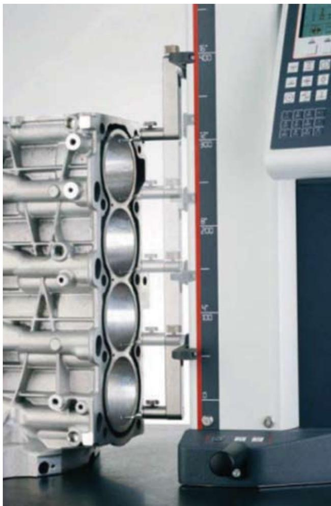
После того, как измерения сделаны, они сохраняются и от определения высот, средних точек, диаметров и их взаимного расположения вас отделяет лишь одно касание клавиши. Кроме того автоматизация высотомеров с цифровым управлением и электроприводом ускоряет процесс измерений и обеспечивает все более высокую повторяемость измерений, исключая оператора из измерительного цикла.
