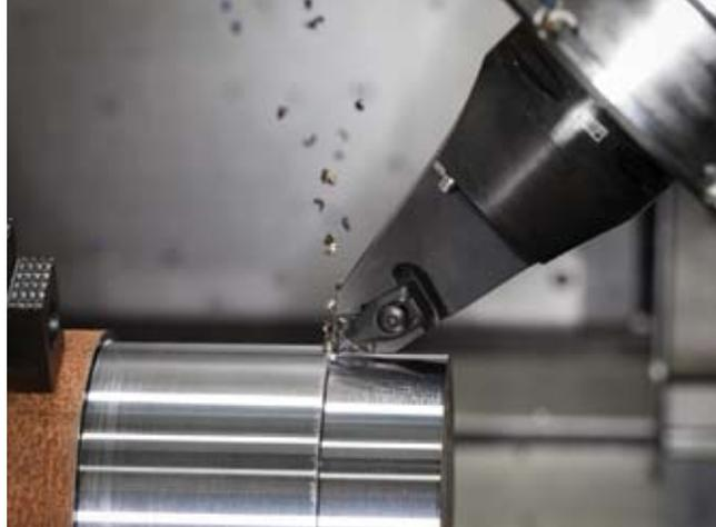
GC4325 обладает более высокой стойкостью за счёт сохранения работоспособной режущей кромки, позволяющей эффективно резать металл без снижения качества обработанной поверхности
