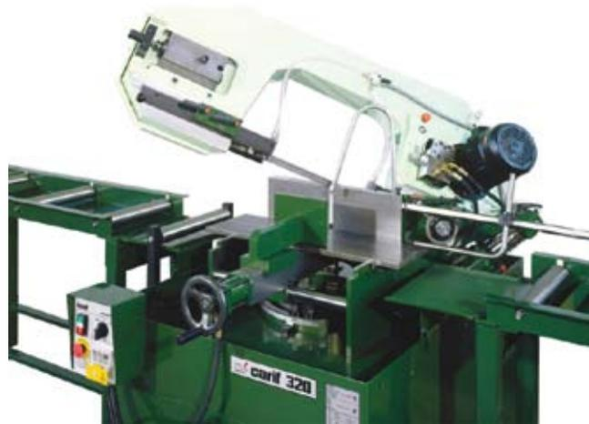
При высоких нагрузках и резке твердых металлов, таких как различные стали, титановые и никелевые сплавы, используются водоэмульсионные СОЖ. Они предотвращают перегрев полотна и материала и удаляют стружку, образующуюся при работе. В охлаждении нет необходимости только при распиле чугуна, алюминия и неметаллических материалов.
