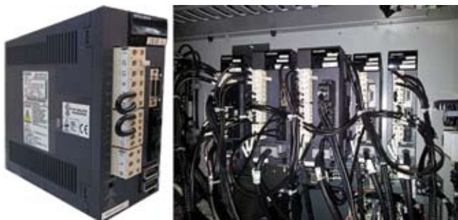
Сервоусилитель MeIServoJ3 и комплект таких усилителей станка Mitsubishi MV1200R
