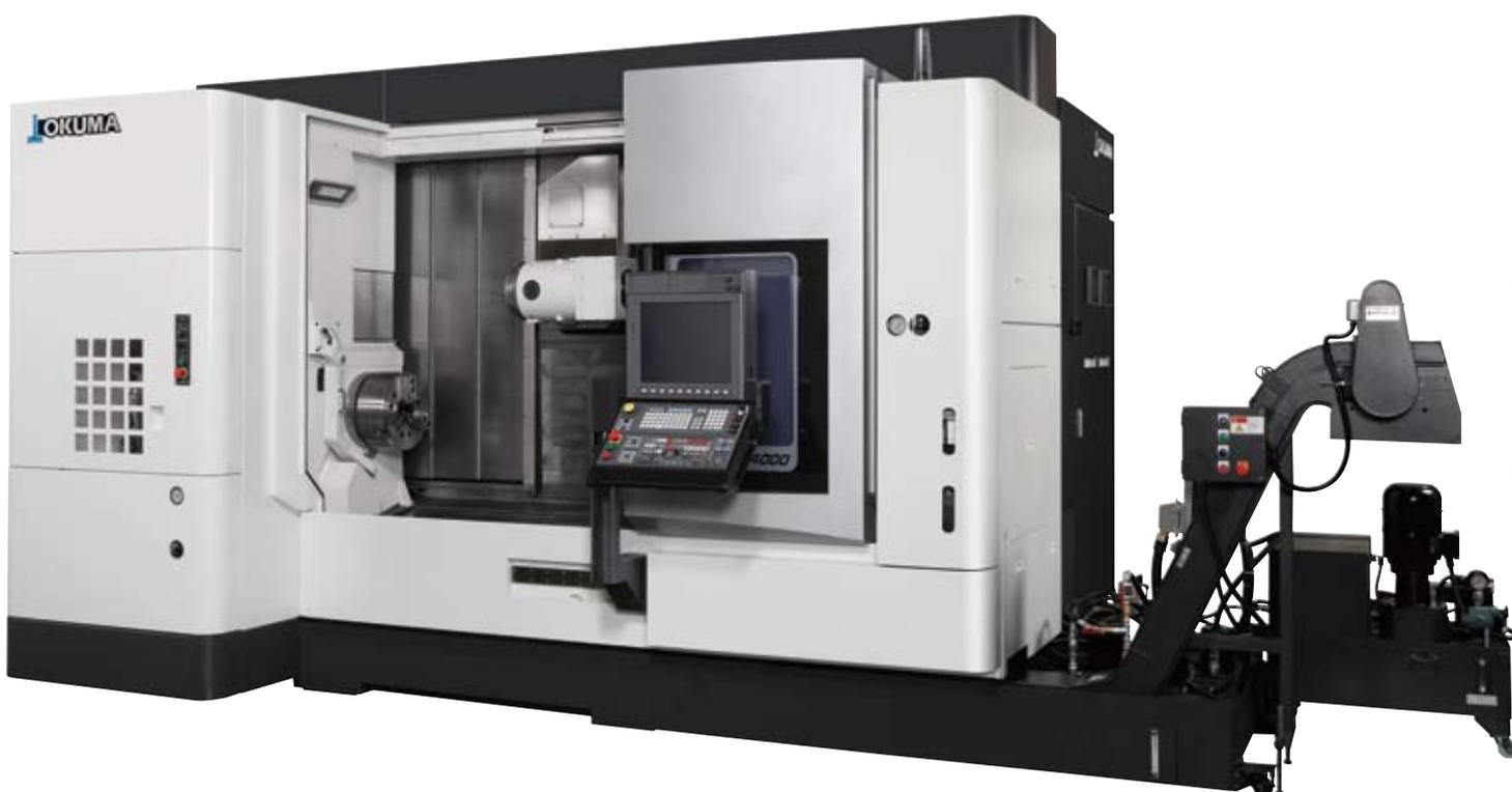
ти (Thermo-Friendly Concept) позволяет станкам в автоматическом режиме компенсировать изменения температуры путем внесения коррекций в программу обработки. Также это дает возможность сохранять точностные характеристики даже при работе оборудования без предварительного прогрева и в цехах без специальной системы кондиционирования воздуха.
