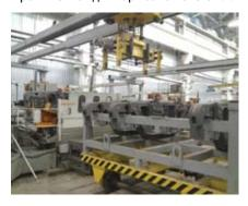
Комплекс для обработки детали «Балка надрессорная» работает в трехсменном режиме с тактовой производительностью 12 шт/час. В его состав входят специальные станки для обработки подпятниковых мест, поверхностей под скользуны, отверстий под крепление державки мертвой точки и отверстий под крепление скользунов, а также специальные станки для обработки наклонных поверхностей под клинья фрикционные.
