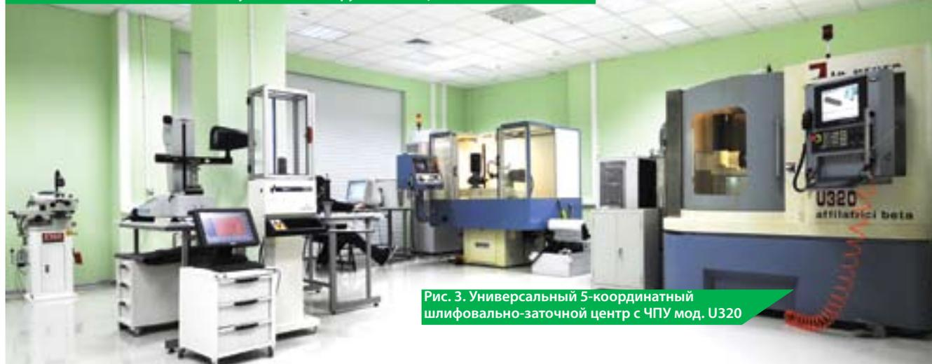
Рис. 3. Универсальный 5-координатный шлифовально-заточный центр с ЧПУ мод. U320
