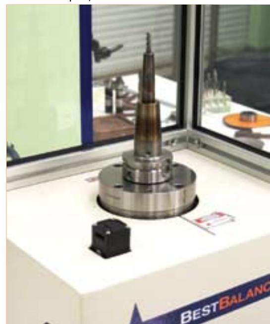
Рис. 6. Балансировка наладки инструмента
