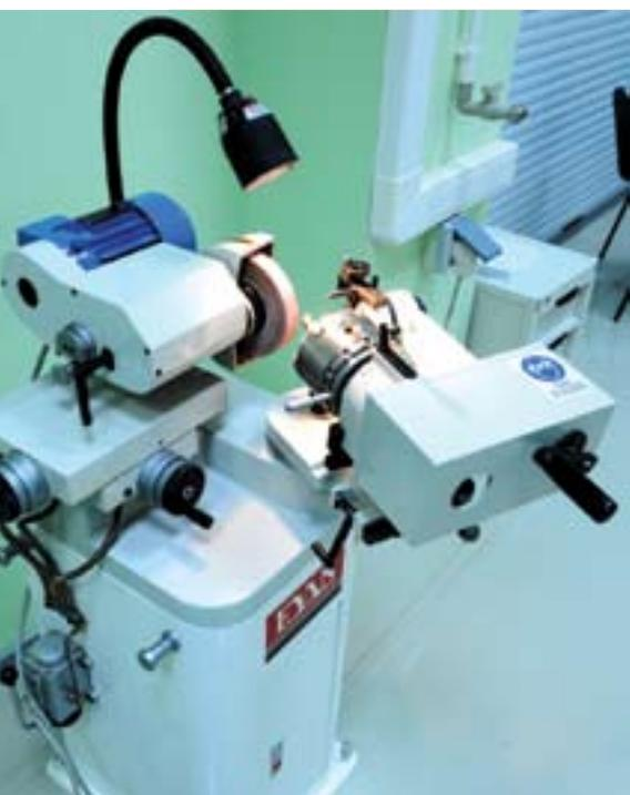
Рис. 4. Заточной станок мод. YF32A
