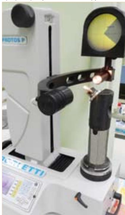
Рис. 5. Настройка расточной оправки на диаметр обработки на устройстве фирмы Borletti
