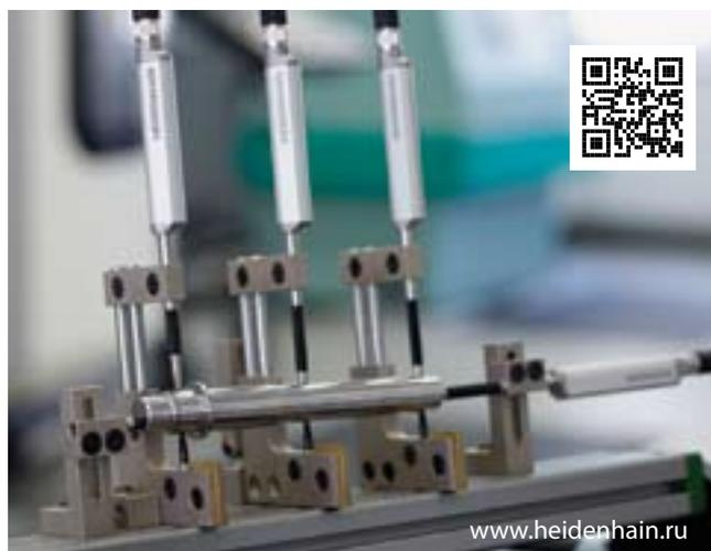
лютной дорожки. Кроме того, в память измерительного щупа можно записать дополнительную информацию производителя оборудования. Инновационные направляющие скольжения обеспечивают перемещение измерительного штока без износа и без потерь на трение.
