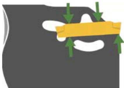
4-точечная система закрепления пластин в отрезном лезвии **G 1042**, что гарантирует простоту обслуживания и надёжность закрепления пластин **GX**.
