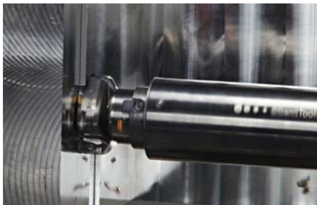
Два исполнения фрезерных антивибрационных оправок имеют вылеты 4-5 и 6-7 x D соответственно
