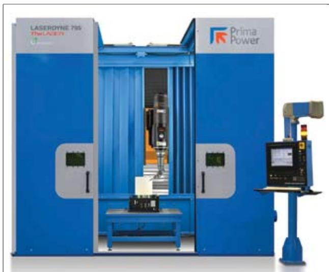
**Возможности многоосевой системы лазерной обработки Laserdyne 795XL позволяют выполнять обработку заготовок больших размеров для производства компонентов турбин благодаря функции регистрации данных программы обработки.**
