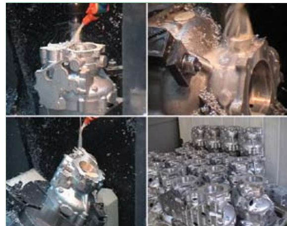
Рис. 12. Результат программирования ЧПУ с ADEM CAM Expert
