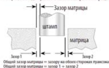
Рис. 3а. Независимо от толщины материала, рекомендуемое проникновение пуансона в матрицы Slug Free® должно составлять 0,118" (3,00 мм)
