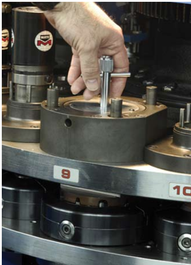
Рис. 2. Юстировка станции займет считанные минуты, если использовать систему калибровки Mate Pilot™. Ее применение позволяет изготавливать детали высокого качества с минимальным износом инструмента.
