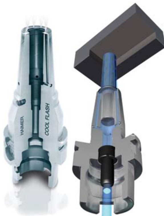
Оправка, оснащенная системой Cool Flash, в разрезе: диск со шлицами на вершине оправки способствует скольжению СОЖ по канавкам инструмента до его вершины.
