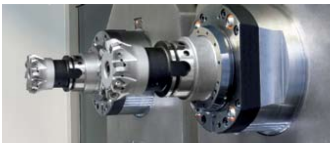
Центр BA 422 предназначен для обработки компонентов средних размеров (до 400 мм)
