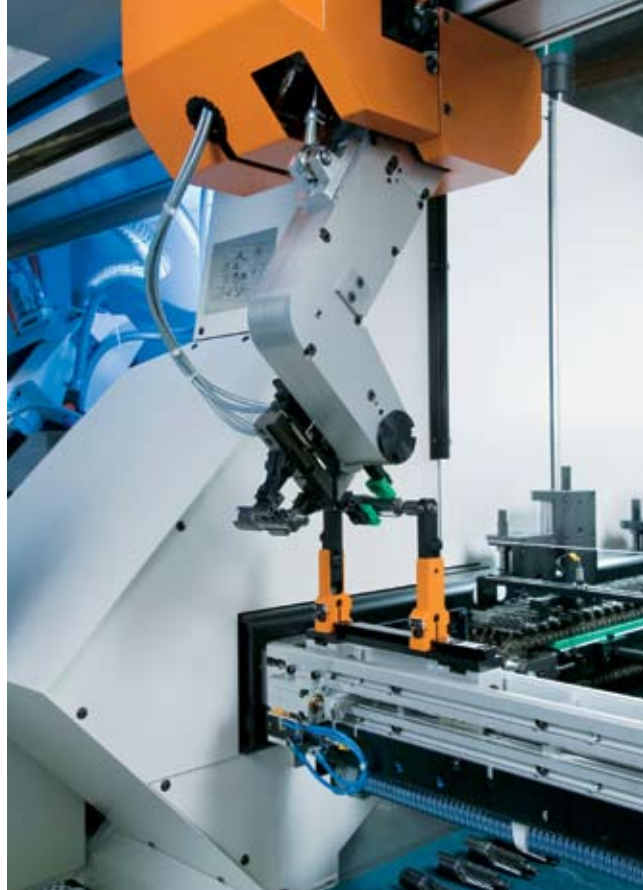
Гибкий загрузочный портал со двоянным поворотным грейфером позволяет покупателям станков KOEPPER резко снизить вспомогательное время при обработке.
