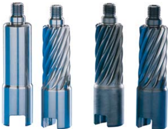
Типичным примером деталей рулевых систем являются рулевые шестерни. На фотографии представлены различные стадии производственного процесса – токарная обработка, предварительное зубофрезерование (незакаленной детали) с ориентацией по лыске, закалка и завершающее твердое «бреющее» зубофрезерование предварительно обработанной и закаленной детали.
