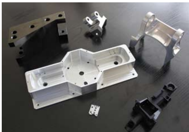
Номенклатура из спектра деталей, около 375 «живых» деталей изготовлены на фирме Mawatec AG из обрабатываемых резанием материалов: металл, пластмасса и композит
