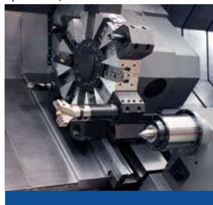
Планшайба револьверной головы выполнена точением и фрезерованием из термообработанной стальной заготовки на заводе Samsung с последующей закалкой на твердость 45 HRC. Поверхности планшайбы отшлифованы. Компания Samsung не использует отливки для изготовления планшайб револьверной головы, т.к. срок службы при таком изготовлении гораздо меньше.
