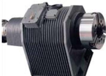
Равномерно распределенная по размеру отливка вокруг шпинделя обеспечивает равномерный и эффективный теплоотвод от шпинделя, что позволяет избежать погрешностей, связанных с прогревом шпинделя. В подавляющем большинстве случаев такая конструкция позволяет начать работу и исключить прогрев шпинделя.
