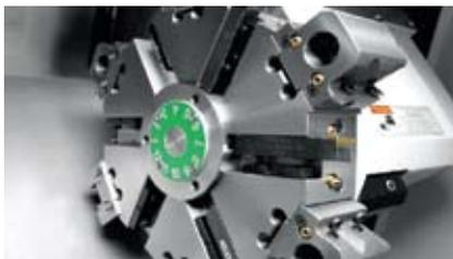
Станки с приводным инструментом используют систему крепления инструментальных блоков BMT для инструментальных голов BMT-65 (BMT-75), что обеспечивает лёгкость базирования при смене инструментальной оснастки и максимально высокую жесткость инструментальной системы по сравнению с системой крепления VDI.
