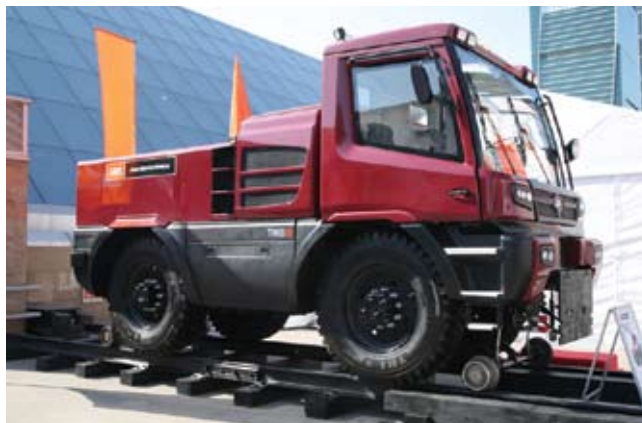
Тяговый модуль вагонов ТМВ-2 в исполнении на комбинированном рельсо-коловом ходу предназначен для выполнения маневровых и поездных работ, а также транспортировки инструмента и груза при проведении специальных или аварийно-восстановительных работ.
