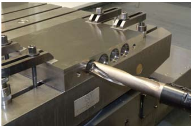
Важнейшая деталь — корпус из нержавеющей стали для вращающегося золотника. На иллюстрации слева сверло Xtra-tec® Insert Drill со сменными пластинами (диам. 43 или 48) мм обрабатывает отверстие глубиной до 5xD. В центре иллюстрации справа представлен готовый корпус на собранной машине.
