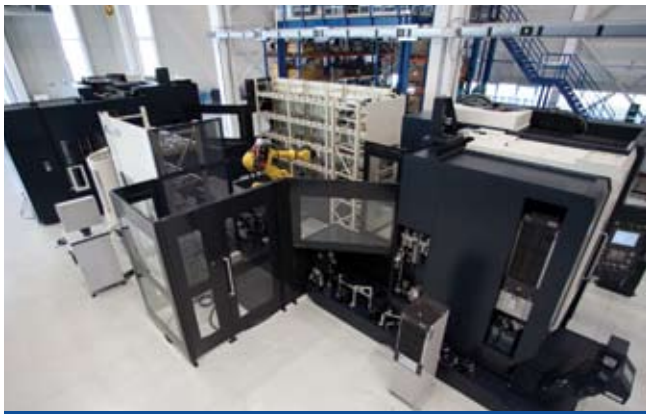
Рис. 5. Два станка D500 подключены к системе автоматической смены паллет с роботом
