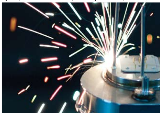
Рис. 4. Лазерная сварка высокоточного электромеханического медицинского оборудования с помощью установки лазерной резки LASERDYNE 430
