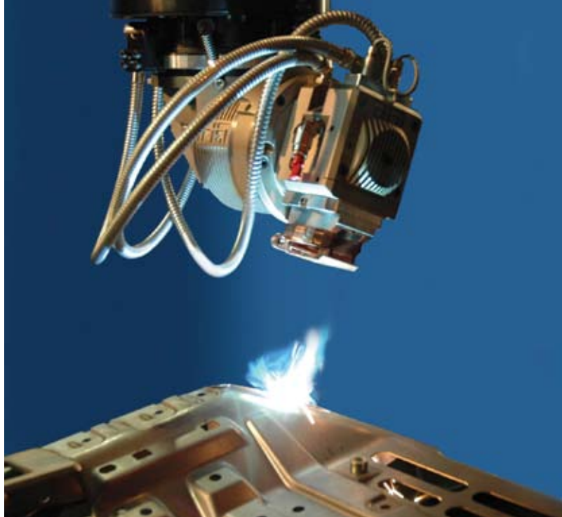
Рис. 1. Сиденье в сборе, изготовленное сваркой внахлестку посредством установки Prima RAPIDO. На заднем плане показан процесс сварки компонентов из низкоуглеродистой стали толщиной 2 и 1,5 мм, используемых при сборке каркаса автомобильного сиденья.
