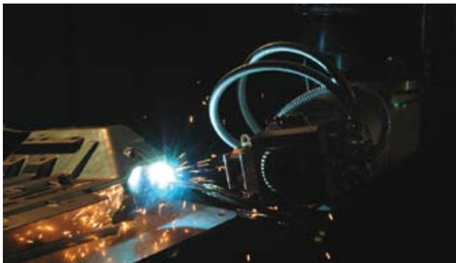
Рис. 6. Лазерная сварка на установке Prima RAPIDO для демонстрации того, что готовые детали автомобилей обладают аналогичной степенью сопротивления ударам, что и детали, изготовленные при контактной сварке, но количество сварных швов уменьшено на 35 %.
