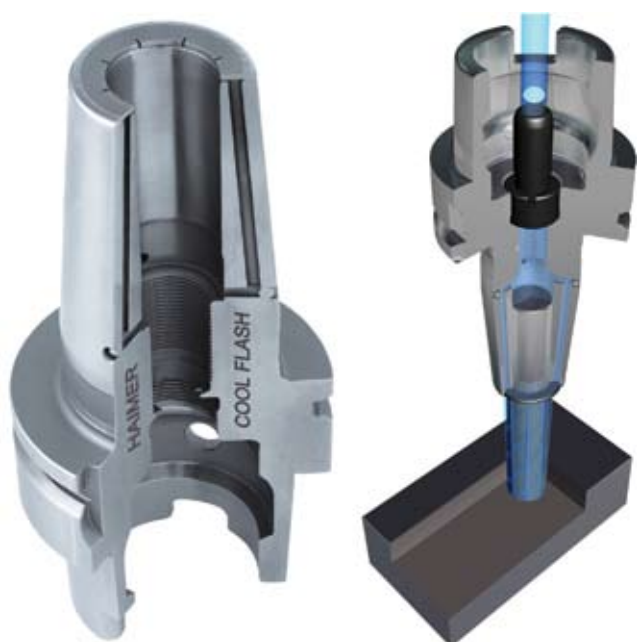
Модель патрона Cool Flash в разрезе: приваренный диск с пазами кольцеобразно направляет поток СОЖ из каналов к режущему инструменту, который скользит вдоль по инструменту до вершины реза
