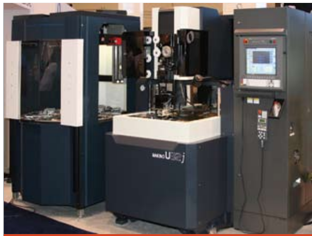
Проволочно-вырезной ЭЭ станок U32j фирмы Makino Inc с автоматизированной загрузкой заготовок
