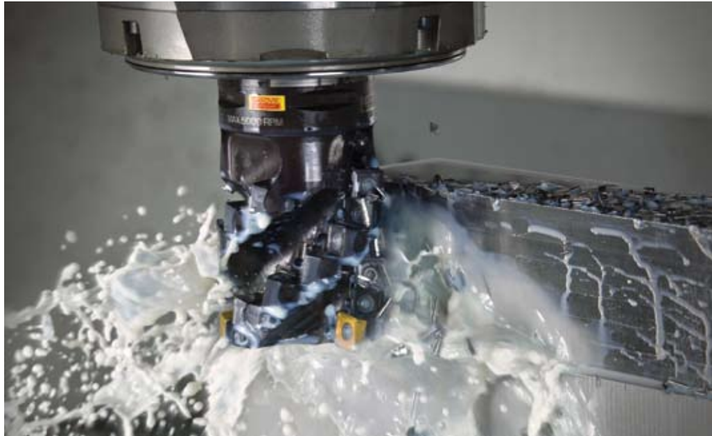
CoroMill 690 – это длиннокромочная фреза, предназначенная для обработки титановых сплавов, с возможностью подачи СОЖ под высоким давлением
