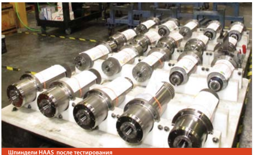
Шпиндели HAAS после тестирования
