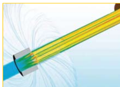
Рис. 3. Без потерь по лезвию: Несмотря на высокую частоту вращения и связанную с ней экстремальную центробежную силу, СОЖ протекает почти без потерь по шейке инструмента до режущей кромки в отверстие. Только при попадании на заготовку происходят минимальные боковые потери
