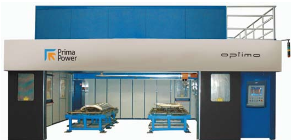
Рис. 2. Установка лазерной резки Synctro 2D производства Prima Power, которая была использована для выполнения отверстий в корпусе Олимпийского факела
