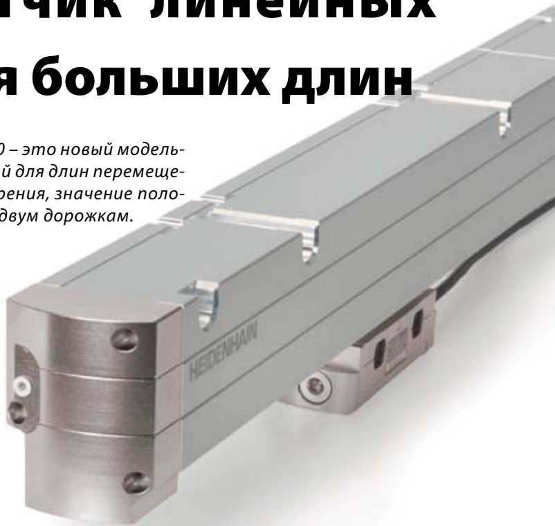
LC 200 – элементы корпуса монтируются на станине, шкала натягивается внутри составного корпуса
