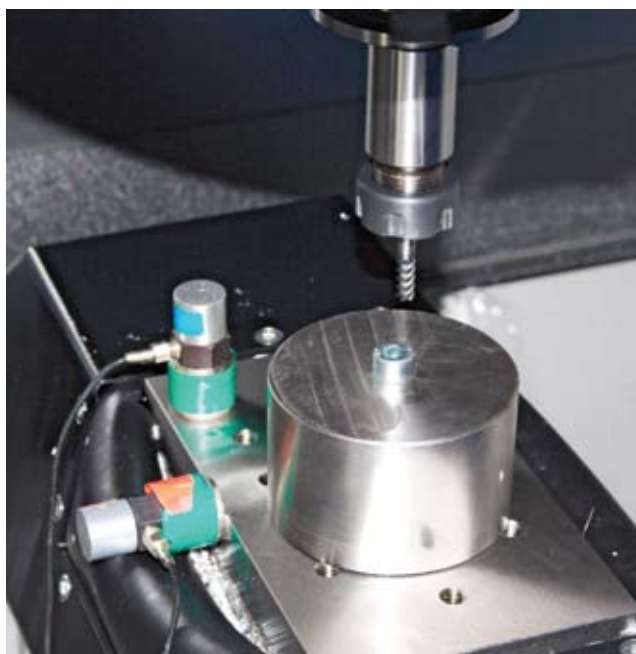
Рис. 2. Заготовка и два акселерометра, установленные на столе динамометра по координатным осям X и Y станка в горизонтальной плоскости
