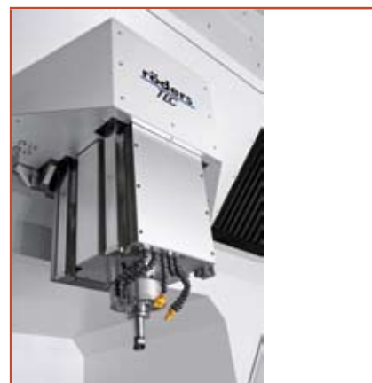
Рис. 2. Головка станка мод. RXU1200DSH с направляющими типа QUADROGUIDE
