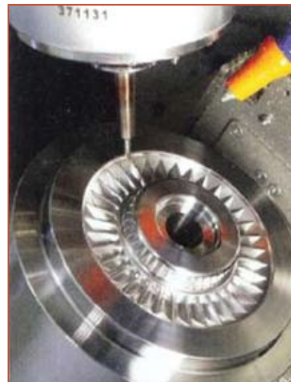
Рис. 5. Пуансон ковочного штампа для горячей штамповки зубчатого колеса диаметром 180 мм
