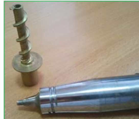
Рис 8. Шнековые поверхности, полученные на токарном оборудовании с применением CAD/CAM/CAPP ADEM
