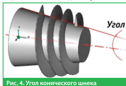
Рис. 4. Угол конического шнека
