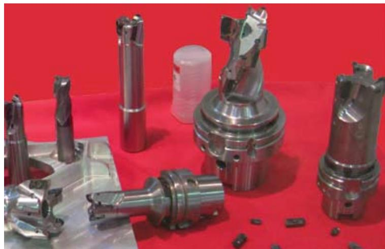
Высокоскоростные фрезы SKIF-M для алюминиевых сплавов
