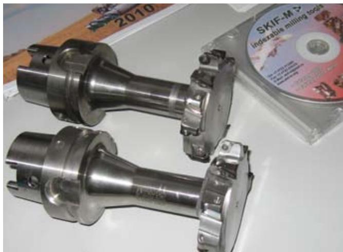
Фрезы SKIF-M специального исполнения для алюминиевых сплавов
