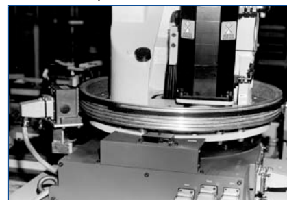
Рис. 17. Механический ограничитель безопасной зоны работы
