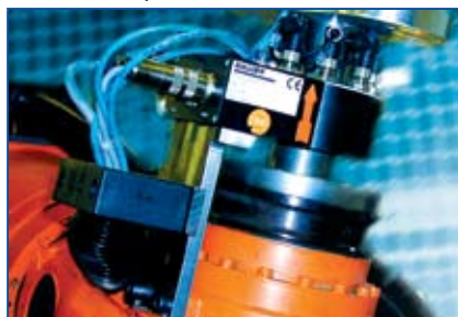
Рис. 16. Индуктивные соединители BIC на промышленном роботе
