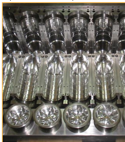
Результат трехкоординатной обработки матрицы пресс-формы в ADEM-VX
