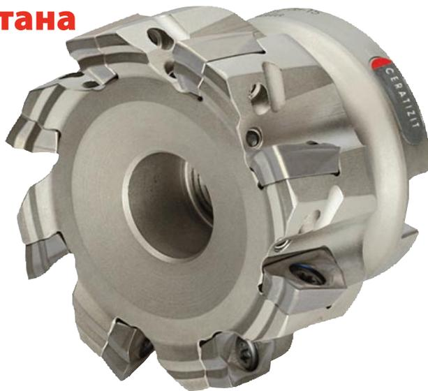
Протестировав новый инструмент в трудных условиях, было обнаружено, что новая фреза может работать на скоростях выше на 15–30 %, чем инструмент конкурентов, и при подаче на зуб до 0,4 мм. Скорость обработки титана фрезой **MaxiMill 211-20** составила около 60 м/мин. В то же время наблюдалось увеличение стойкости на 20–100 %, а иногда и до 200 %.
