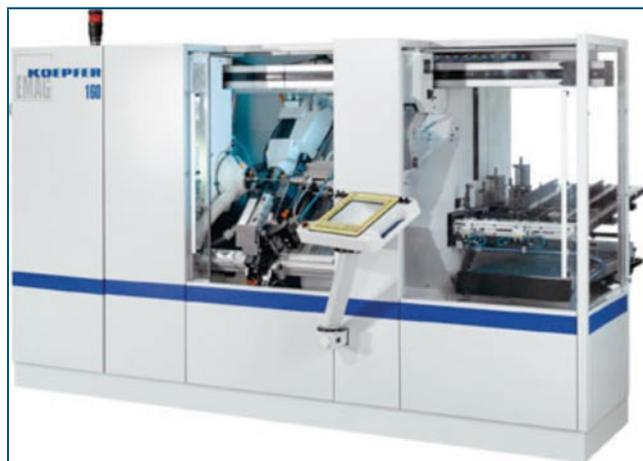
Станок EMAG Коерфер K160 – зубофрезерная обработка деталей за рекордно короткое время.
