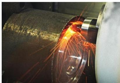
**Обработка сплавом из керамики**
