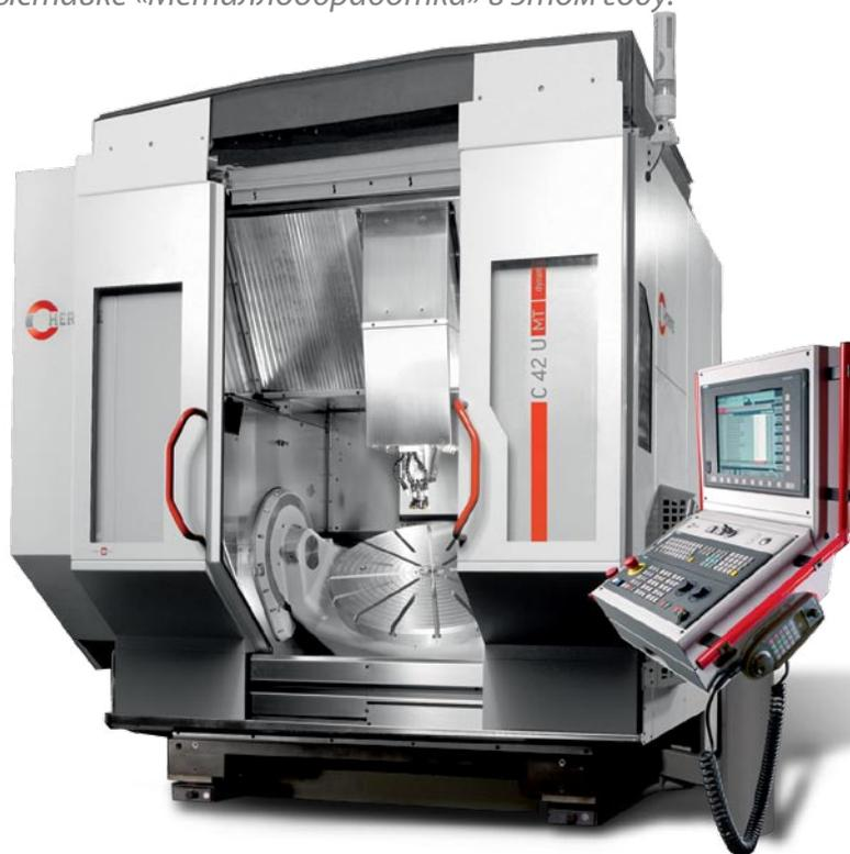
Новинка фирмы Хермле обрабатывающий центр с ЧПУ **C 42 U MT dynamic** теперь с интегрированной функцией точения для обеспечения комплексной обработки. Версия **MT** (MT означает Mill/Turn = фрезерование/точение)
