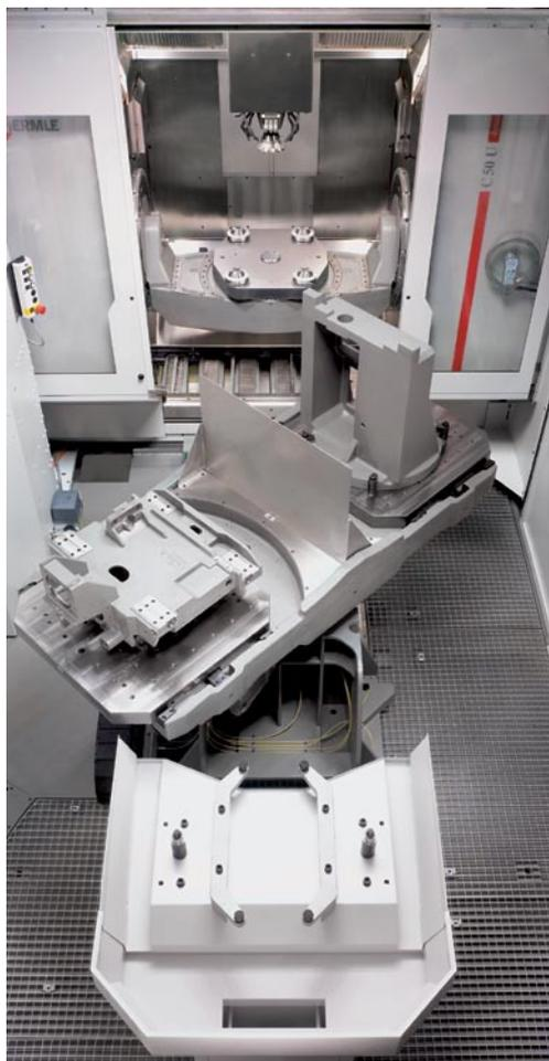
Благодаря соединению обрабатывающего центра ХЕРМЛЕ и робототехнической системы возникает высокопроизводительная, гибкая технологическая производственная система, которая обозначается как **RS 1, RS 2, RS 3** или **RS 4**. Эти системы были разработаны в качестве платформы, могут быть расширены заказчиком под конкретные задачи и могут – при соблюдении принципа модульной организации накопителей – обслуживать до 3 встроенных станков с общей массой до 1000 кг.
