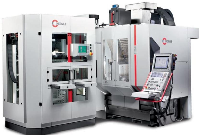
*Системы ИИ являются закрытыми автоматизированными системами для автоматической смены палет или заготовок массой до 100 кг. Они находят применение в обрабатывающих центрах C 20, C 30, C 40 и C 42.*
